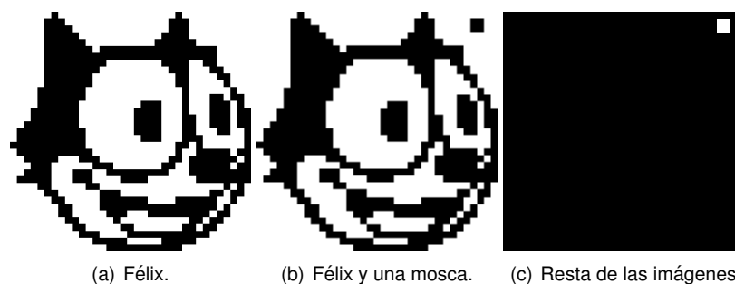
Figura 4.3.5: Hubo movimiento, ya que la imagen resultante de la resta de las imágenes no fue totalmente negra.
